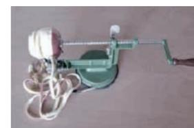
Diese altbekannte Vorrichtung schält innerhalb kürzester Zeit Äpfel und Birnen und teilt sie in Spiralscheiben (à 4 mm Dicke). Die Schälfunktion kann auch ausgeschaltet werden.
